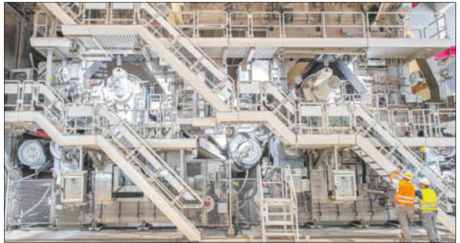
Das Herzstück der Fabrik: eine der modernsten und leistungsfähigsten Papiermaschinen der Welt zur Herstellung von umweltfreundlichen und hochwertigen Wellpappenrohpa-pieren.
